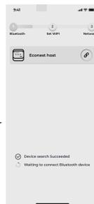
3. Une fois que le dispositif est connecté avec succès, accédez à la page Wi-Fi et connectez-vous au Wi-Fi pour terminer la configuration du réseau.
